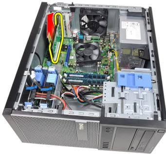
7. Levante a placa de expansão PCI x4 (se existir) para fora do respectivo conector e retire-a do computador.
