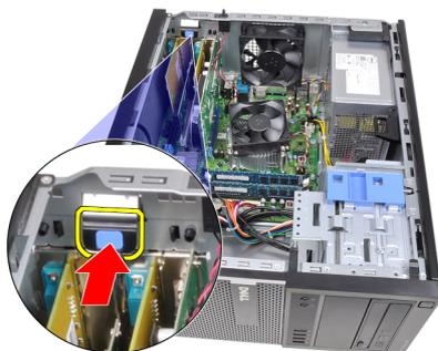
4. Afaste a alavanca de desbloqueio da placa PCIe x16 até soltar a patilha de fixação do entalhe na placa. Em seguida, liberte a placa do respectivo conector e retire-a do computador.
