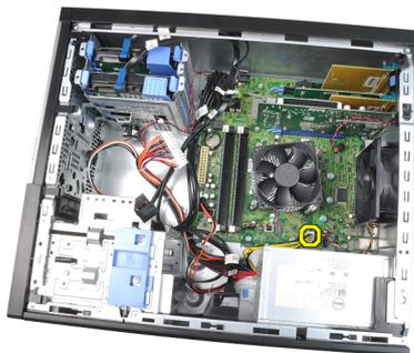
7. Retire os parafusos que fixam a fonte de alimentação à parte posterior do computador.
