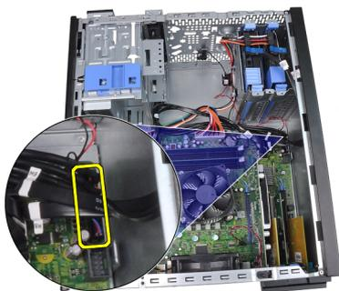
5. Retire o painel de entrada/saída e o cabo FlyWire do grampo no computador.
