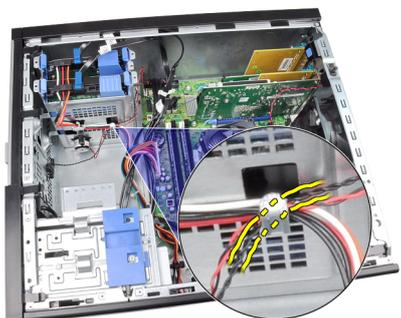
5. Levante e retire o sensor térmico da parte anterior do chassis.
