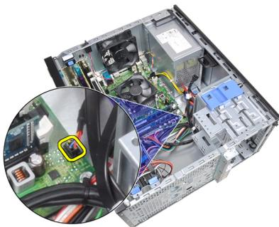
6. Retire o cabo do interruptor de alimentação dos grampos no chassi.
