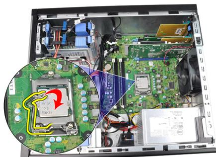
8. Levante o processador para o retirar do encaixe e coloque-o numa embalagem antiestática.
