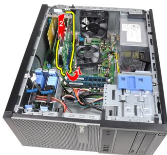
5. Levante a placa de expansão PCIe x1 (se existir) para fora do respectivo conector e retire-a do computador.
