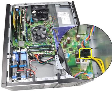
4. Levante a ventoinha do sistema e retire-a dos quatro ilhoses que fixam a ventoinha à parte posterior do computador.
